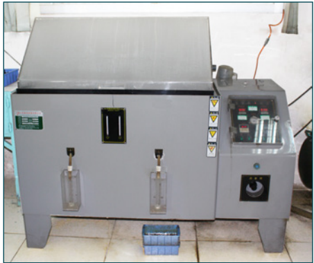
盐雾测试机 Salt Spray Tester
